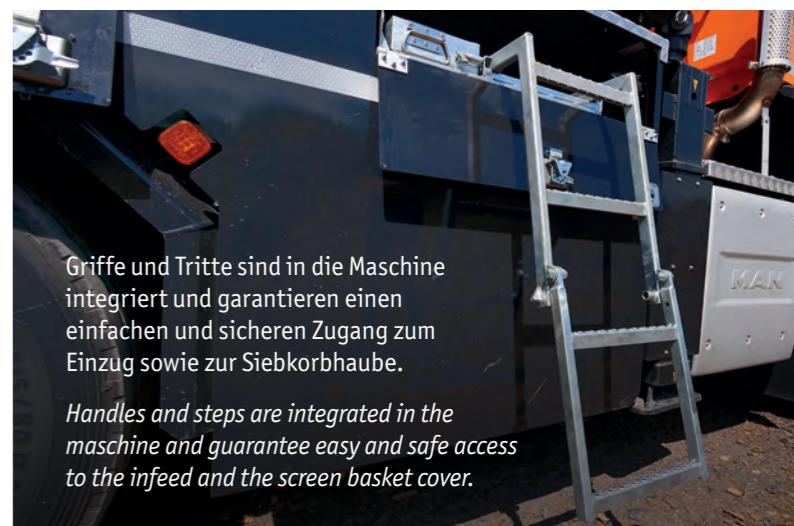
Griffe und Tritte sind in die Maschine integriert und garantieren einen einfachen und sicheren Zugang zum Einzug sowie zur Siebkorbhaube.
