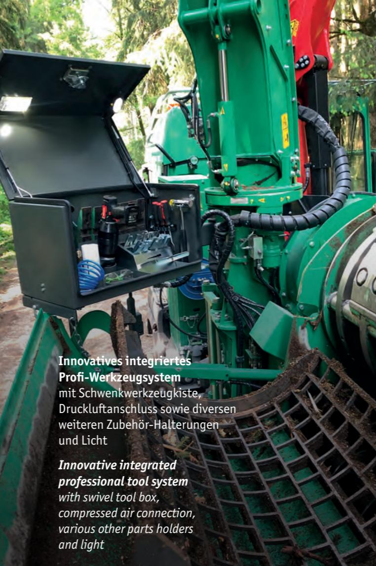
Innovatives integriertes Profi-Werkzeugsystem mit Schwenkwerkzeugkiste, Druckluftanschluss sowie diversen weiteren Zubehör-Halterungen und Licht
