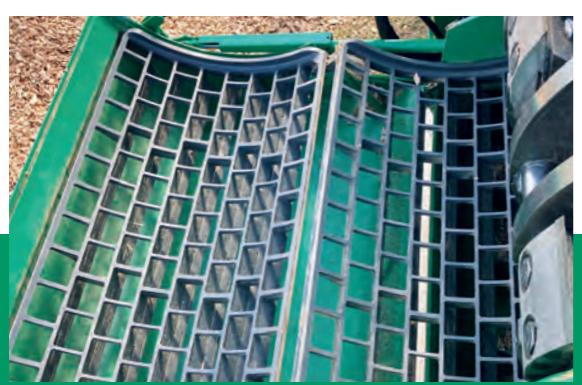
**Lamellen-Siebkorß: Lamellen an der Siebkorßbrückseite verhindern einen Austritt von Überlängen und erzwingen einen erneuten Schnitt**
