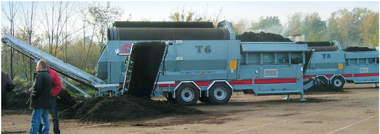
Terra Select Trommelsiebmaschine T5 und T6 beim Vorführtag Fa. van Bommel
