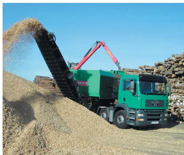
Einsatz als „Terminalhacker“, HEM 700 produziert Qualitätshackschnitzel mit geringstem Feinanteil
