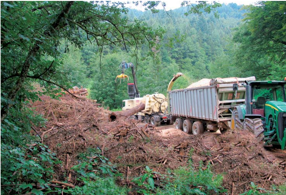
Auf die Logistik kommt es an, fast 40 % der Einsatzzeit gehen durch Rüsten, Rangieren und Warten auf die Schnitzelabfuhr verloren
