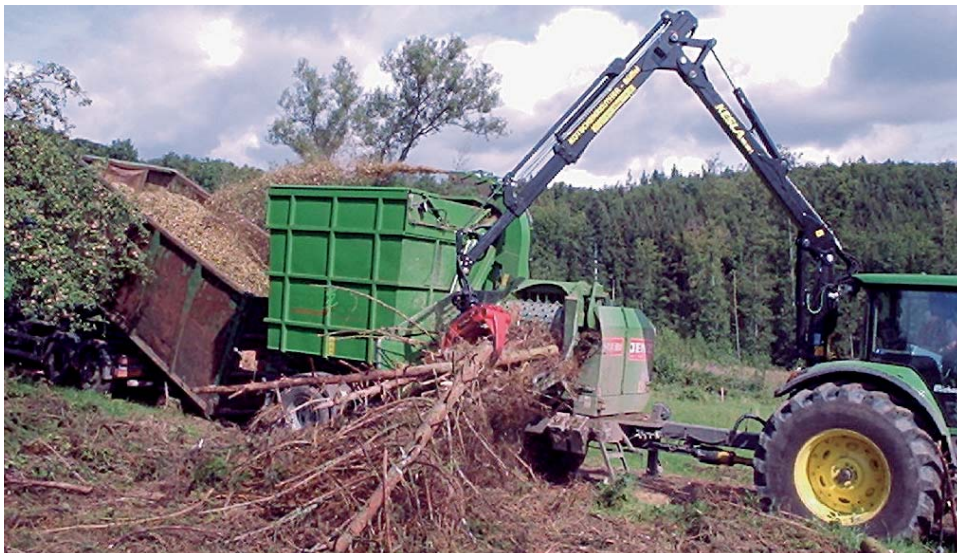
Das starke Wurfgebläse befüllt wahlweise den Bunker oder einen separaten Container
